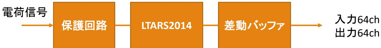
外来ノイズを抑えるため信号伝送には差動信号を使用している
