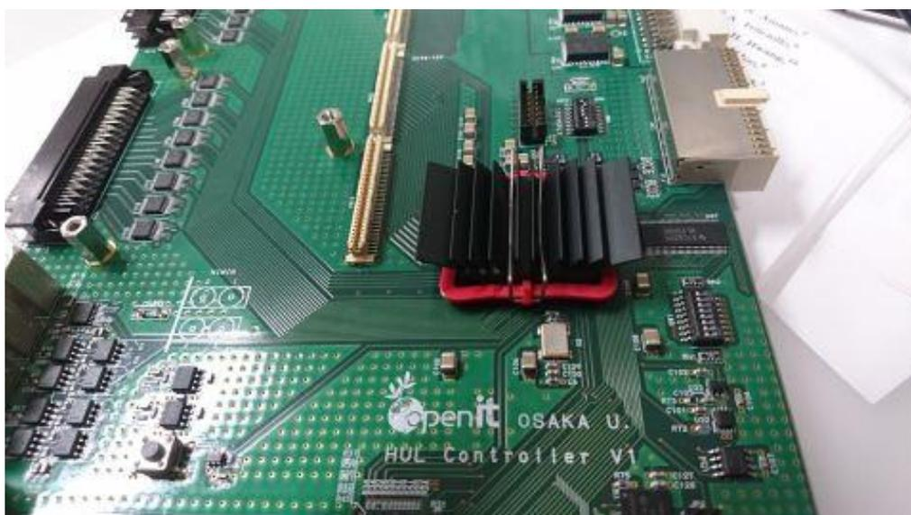
図 29 : ヒートシンクを取り付けた状態の FPGA
