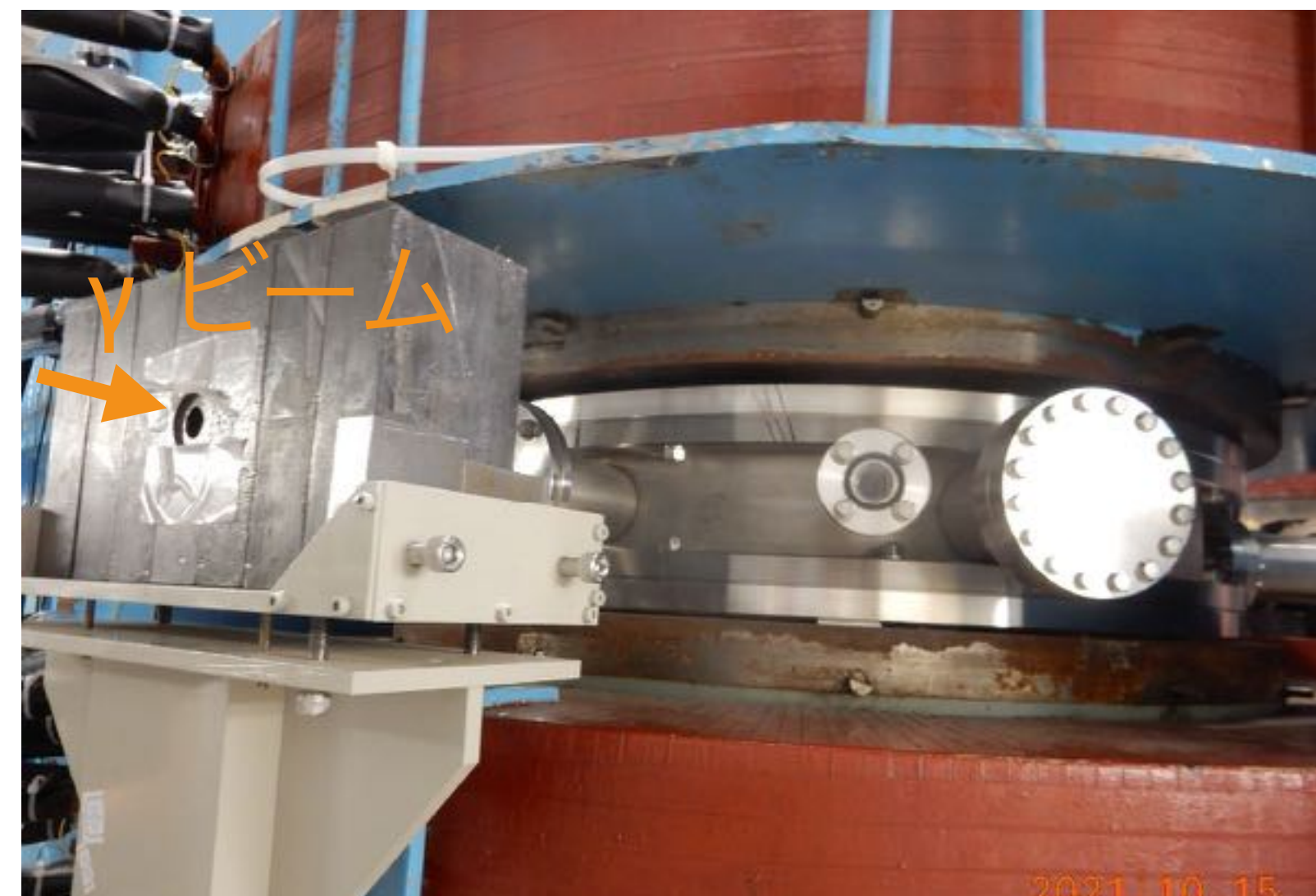
プロダクションターゲット Au 20 \mu\text{m} W 200 \mu\text{m} Cu 8mm など
