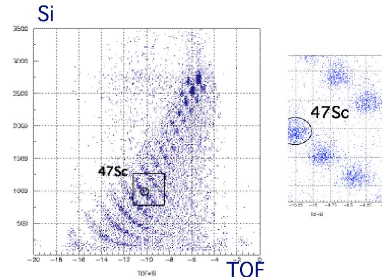
$B_2 \rho_2 = 6.11\text{Tm}$ より F2でのエネルギー  $308\text{MeV/A}$
