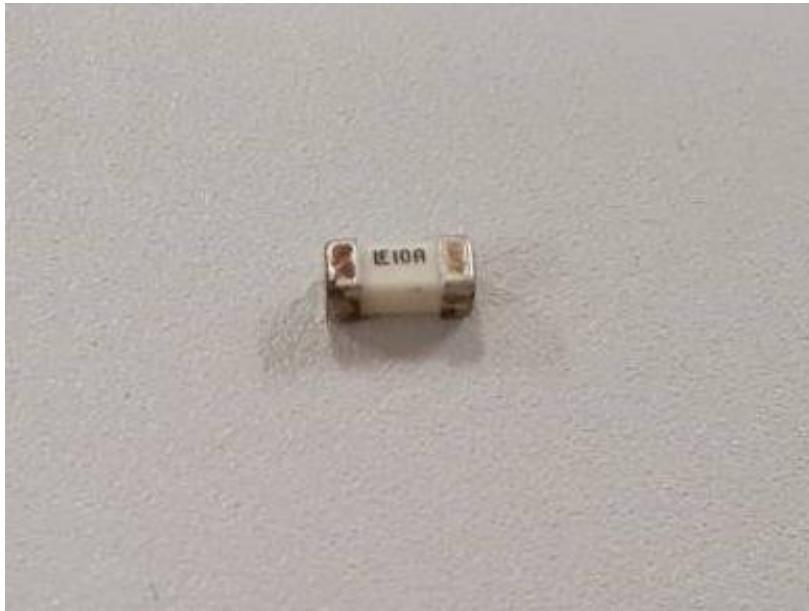
ROCから取り外したヒューズ
