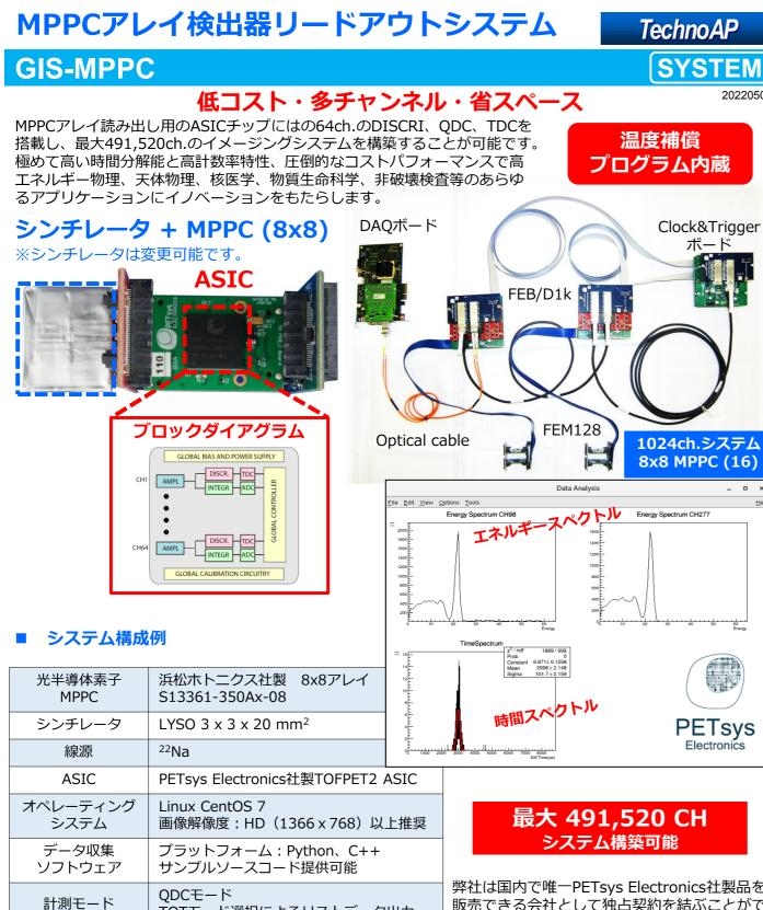
最大 491,520 CH システム構築可能 弊社は国内で唯一PETsys Electronics社製品を 販売できる会社として独占契約を結ぶことがで き低コスト、多チャンネル、省スペースで計測 システムを構築されたい方にこの製品をご紹介
