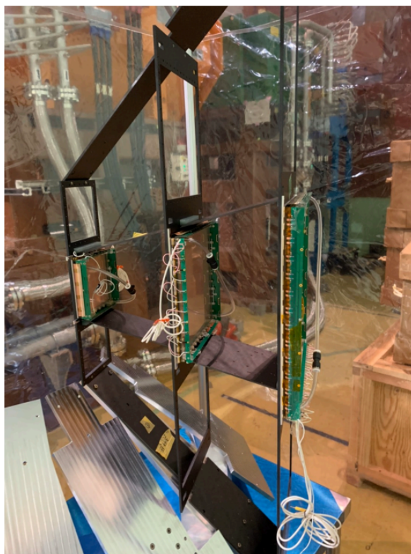
図 2.9: CFRP フレームに取り付けられた GTR.[17]
