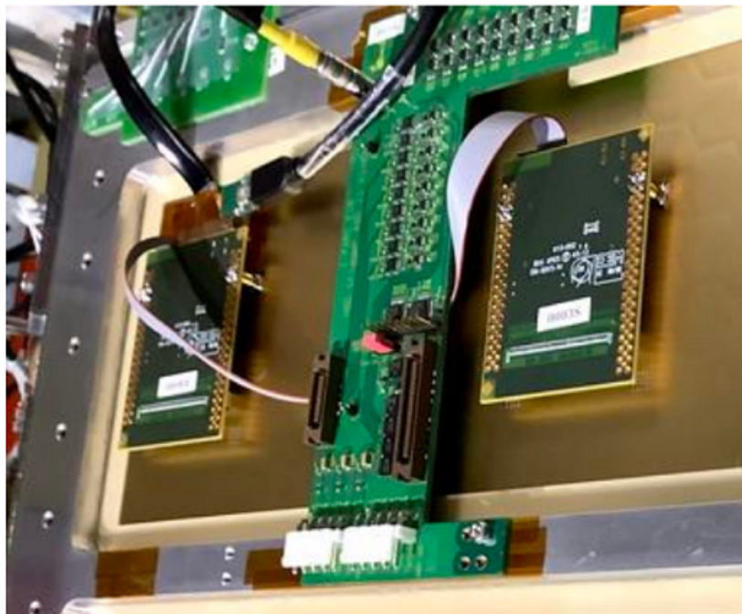
図 2.21: 中央のボードが HBD からのトリガー信号を受ける 9 ch-ASD、左右に繋がる基板が CERN APV25 Hybrid カードである。[29].
