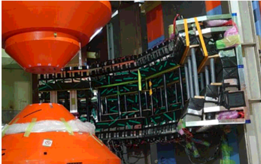
図 2.13: インストールされた LG。鉛ガラスブロックに入射した電子が起こす電磁シャワーによる信号を検出する破壊測定のため、スペクトロメータの最後方に設置する
