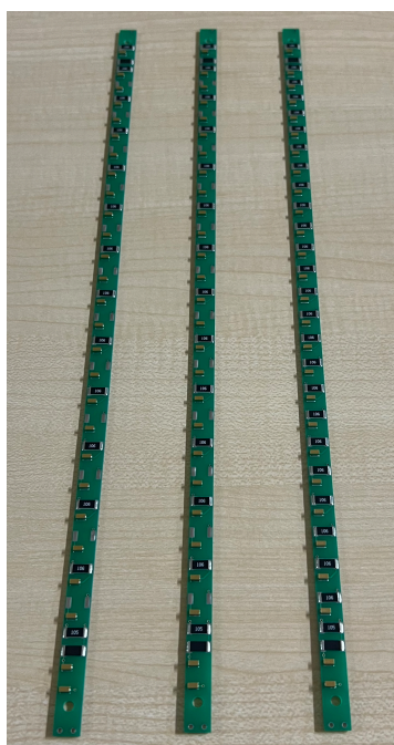
図 2.18 HV 供給基板の写真. 右側の基盤が旧基板. 左側の 2 枚が本研究で開発した新基板である.
