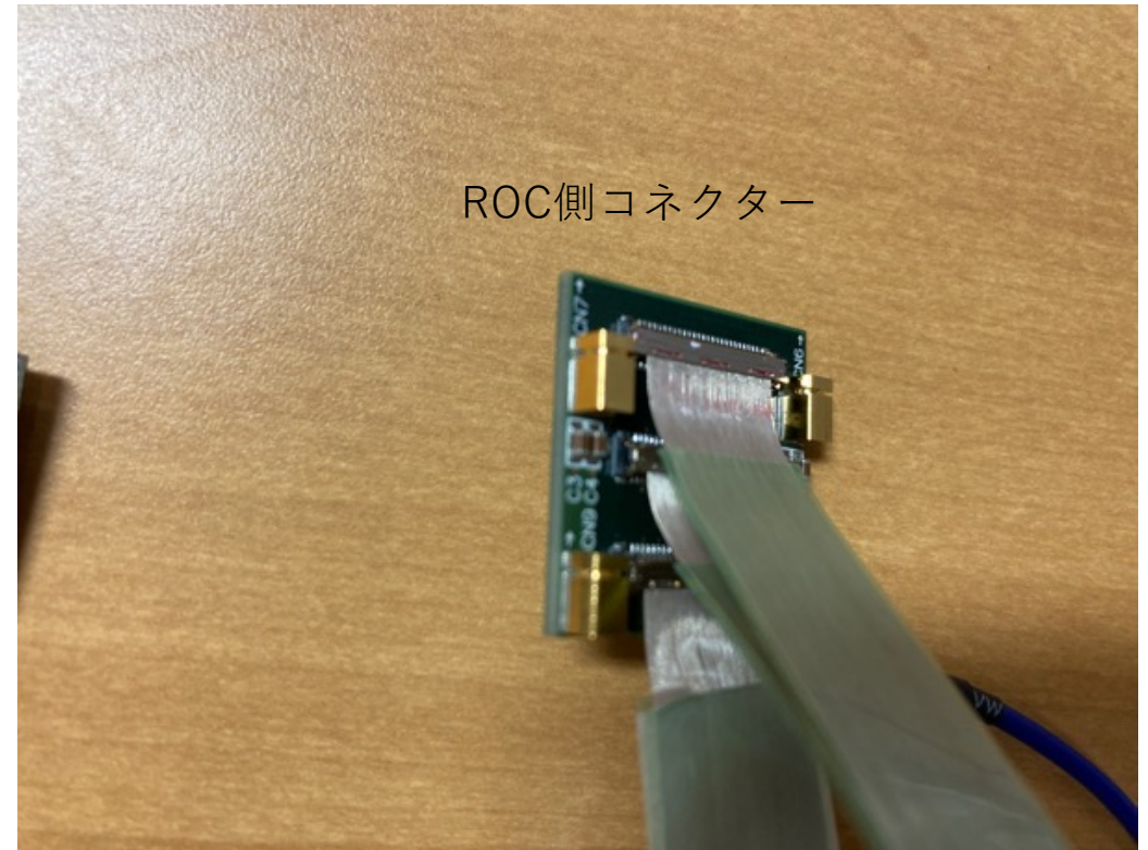
マイクロ同軸の束は基板にコネクターで取り付けられていて、こちらも簡単には抜けません。 3
