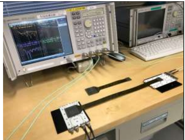
図 4： sパラメーター測定の設定アップ
