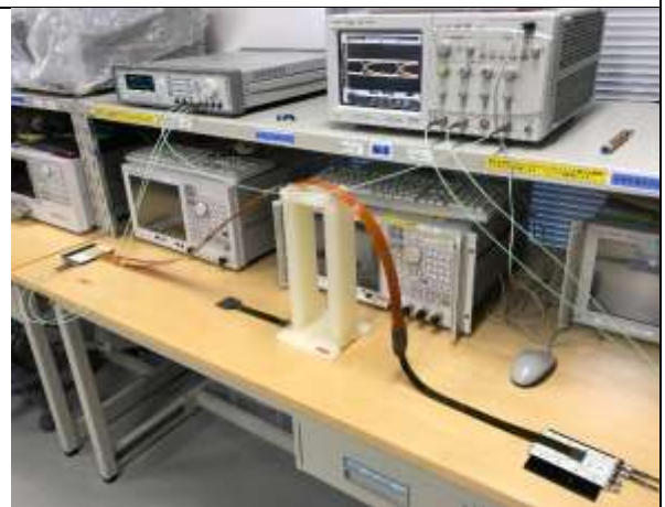
図 6： Eye ダイアグラム測定の設定アップ
