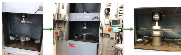
図 4.4 万能試験機が試験片を押し曲げる様子
