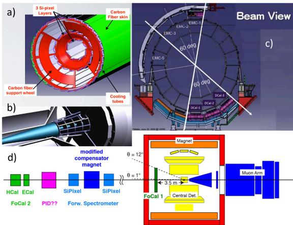
図 2.5.25: ALICE upgrade 計画. a) 最内層 vtx 検出器、b) 前方 vtx 検出器、c)DCAL, d)FoCAL と前方スペクトロメータ [32]
